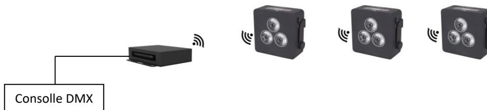
Per collegare il trasmettitore alla consolle DMX Utilizzare un cavo conforme alle specifiche EIA RS-485: bipolare intrecciato, schermato, 120Ohm di impedenza caratteristica e bassa capacità (SAGITTER SG DMX3 – SG DMX5).
