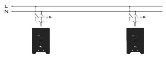
Il dispositivo deve essere collegato ad un sistema di alimentazione dotato di un'efficiente messa a terra. Inoltre, si consiglia di proteggere le linee di alimentazione dei prodotti dai contatti indiretti e/o da cortocircuiti verso massa utilizzando interruttori differenziali opportunamente dimensionati.
