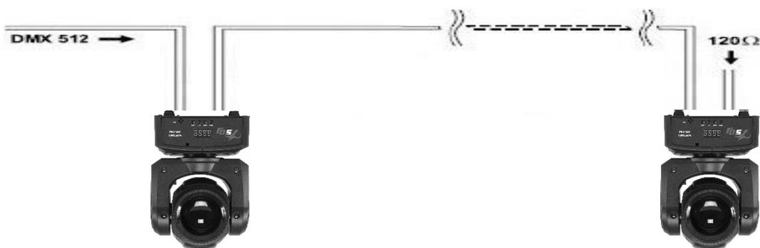
Utilizzare un cavo conforme alle specifiche EIA RS-485: bipolare intrecciato, schermato, 120Ohm di impedenza caratteristica e bassa capacità (SAGITTER SG DMX3 – SG DMX5).
