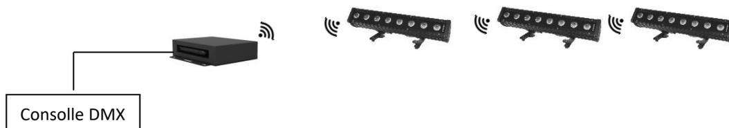
Per collegare il trasmettitore alla consolle DMX Utilizzare un cavo conforme alle specifiche EIA RS-485: bipolare intrecciato, schermato, 120Ohm di impedenza caratteristica e bassa capacità (SAGITTERSG DMX3 – SG DMX5).
