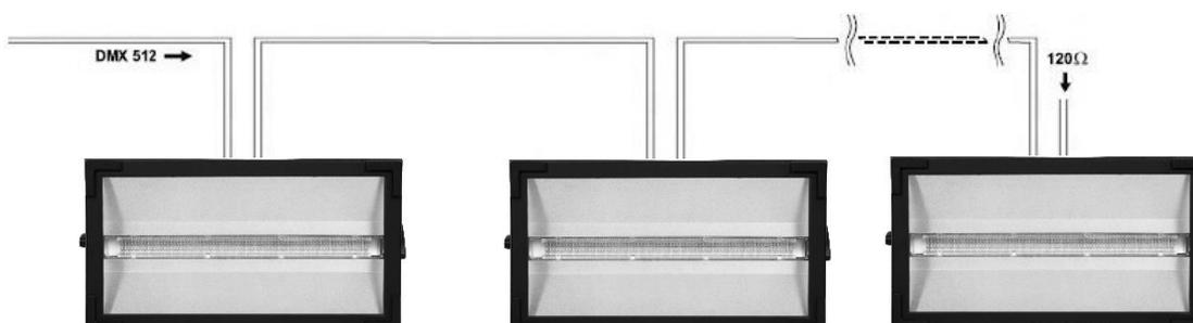
Utilizzare un cavo conforme alle specifiche EIA RS-485: bipolare intrecciato, schermato, 120Ohm di impedenza caratteristica e bassa capacità (SAGITTER SG DMX3 – SG DMX5).
