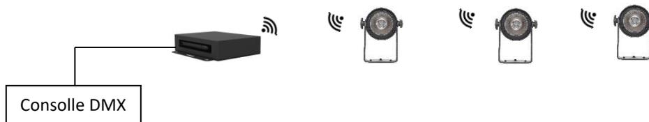
Per collegare il trasmettitore alla consolle DMX Utilizzare un cavo conforme alle specifiche EIA RS-485: bipolare intrecciato, schermato, 120Ohm di impedenza caratteristica e bassa capacità (SAGITTER SG DMX3 – SG DMX5).
