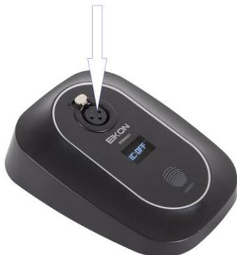
2. Collegare la base microfonica al mixer o all'amplificatore mediante un cavo (XLR maschio / XLR femmina).
