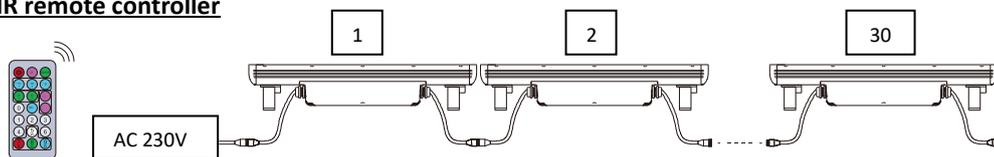
Collegare massimo 30 barre (AC 230V) o 15 barre (AC 110V) in catena, impostare la prima barra in modalità colori statica (STAT COLO) o automatica (AUTO), le rimanenti 29 barre o 14 barre dovranno essere impostate in modalità SLAVE
