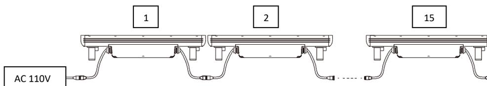
Il dispositivo deve essere collegato ad un sistema di alimentazione dotato di un'efficiente messa a terra. Inoltre, si consiglia di proteggere le linee di alimentazione dei prodotti dai contatti indiretti e/o da cortocircuiti verso massa utilizzando interruttori differenziali opportunamente dimensionati.
